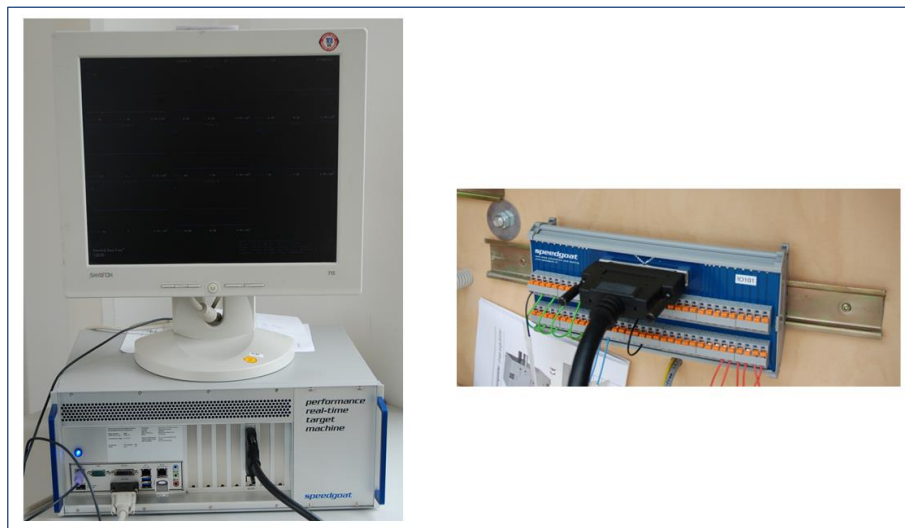
Abbildung 8.2.3-22: Echtzeitsystem "Speedgoat" (l), direkte Anbindung der Datenpunkte an die DDC (r)
