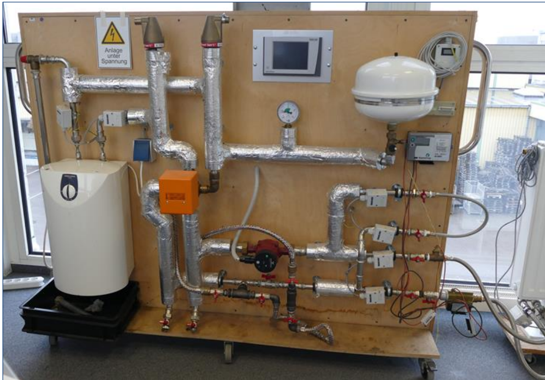
Abbildung 8.2.3-21: Teststand autarker Heizkreis (Kieback&Peter)
