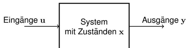
Abbildung 6.1-4: System mit Eingängen, Ausgängen und Zuständen
